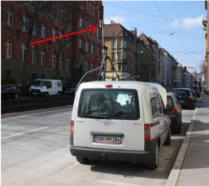
Abbildung 4.2: Stationäre Messung mit dem Stativ auf dem Autodach. Die Luft wird mit dem Schlauch am Stativ (roter Pfeil) auf ca. 3 m Höhe eingesaugt.
