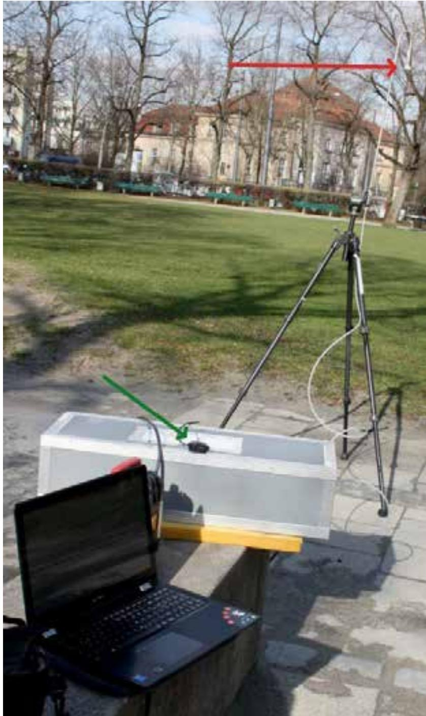
Abbildung 3.2: Foto des Messgerätes in Verwendung. Zu sehen sind das Gerät selbst in grau mit aufliegendem schwarzen GPS-Messgerät (grüner Pfeil), das Stativ mit dem weißen PTFE-Schlauch zum Einsaugen der Messluft (wobei das Ende nach unten gebogen ist, um eindringende Nässe bei Regen zu verhindern / roter Pfeil), sowie der Laptop, der über W-LAN erlaubt, das Gerät zu steuern und direkt eine erste Auswertung zu berechnen.
