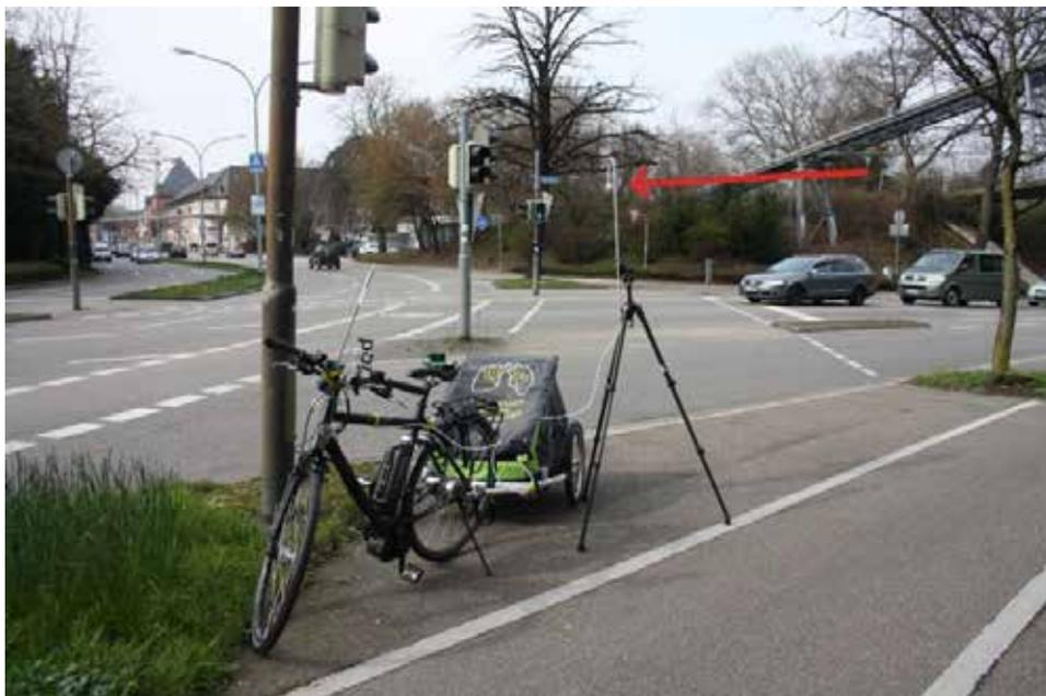
Abbildung 4.3: Stationäre Messung mit dem Stativ. Das Messgerät befindet sich im Anhänger des Fahrrads. Die Luft wird hier ebenfalls mit dem Schlauch am Stativ (roter Pfeil) eingesaugt.
