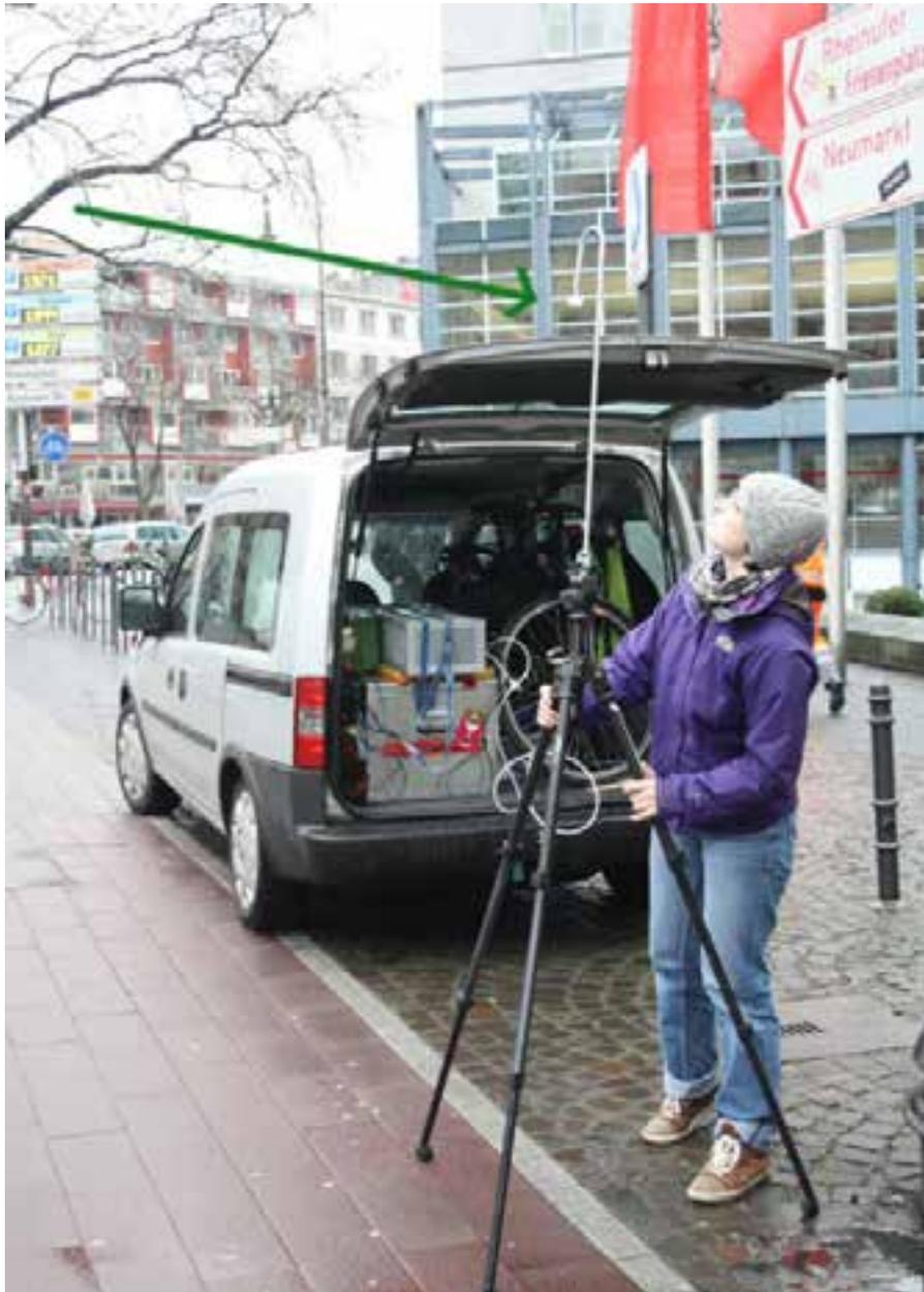
Abbildung 4.1: Stationäre Messung mit dem Stativ. Das Messgerät befindet sich im Kofferraum des erdgasbetriebenen Fahrzeugs. Die Luft wird mit der Messleitung am oberen Stativende (grüner Pfeil) eingesaugt.
