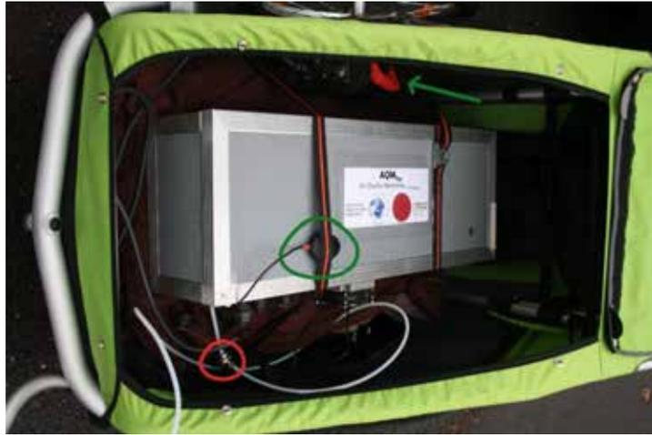
Abbildung 4.5: Messgerät im Anhänger. Mit Stromversorgung (grüner Pfeil) und GPS-Messgerät (roter Kreis).
