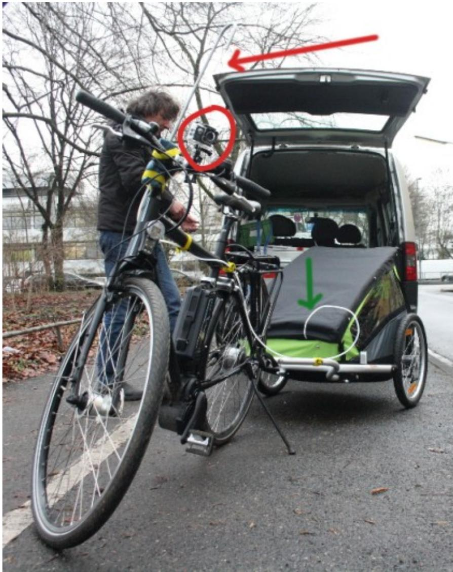
Abbildung 4.4: Zur Messung verwendetes Fahrrad mit elektrischer Unterstützung. Der rote Pfeil zeigt an, wo die zu vermessende Luft am Lenker angesaugt wird (nahe der Nase des Fahrradfahrers). Sie wird dann über den weißen Schlauch entlang des Fahrradrahmens zum Messgerät im Anhänger geführt (grüner Pfeil). Der rote Kreis markiert die Kamera, welche beim Fahren regelmäßig Fotos aufzeichnete.
